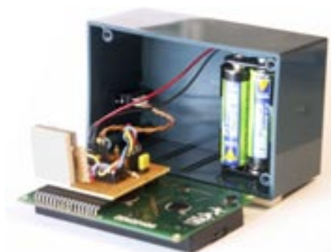
Aufbau mit Batteriefach und 4x20 LCD-Modul (liegend).
